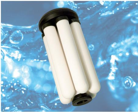
El Rio 2000 es un módulo patentado diseñado para acoplarlo a los soportes Jumbo de 10 pulgadas de gran capacidad estándar en la industria. El módulo es reutilizable por lo que sólo hay que reemplazar las 6 minibujías filtrantes Sterasyl™ incluidas en el mismo.
